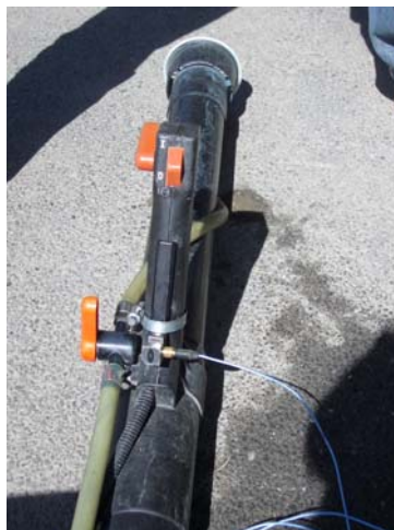
Fig. 2. Esempio di fissaggio degli accelerometri all'impugnatura dell'atomizzatore spalleggiato.
